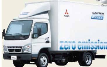
欧州向けの小型トラック「キャンター-3S13」をベースに、リチウムイオンバッテリー(40kWh)とモーター(出力70kW、最大トルク300Nm)を組み合わせた小型電気トラック。10時間(200V)の充電で約120kmの航続走行を可能とする。車両総重量は3.5t。
