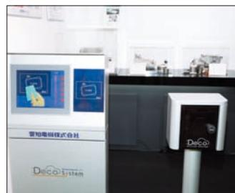
電気自動車普及充電システム「Deco system」を展示していたのは、愛知電機株式会社。これは複数台の電気自動車またはプラグインハイブリッド車を同時に充電する場合、充電時間を分散させて電力の契約容量を超えないように制御する「負荷平準化機能」(特許出願中)を搭載している
