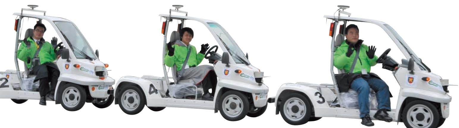
先頭車両に追従して、無駄のない効率的な走行を実現。アクセルやブレーキ操作だけではなく、ステアリング操作も一切必要ない。各社の技術を統合することで、将来的には自動運転を実現し、省エネ効果を發揮する
