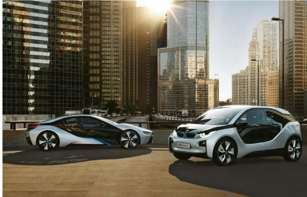
一方、「BMW i8」は170psのモーターで前輪を駆動し、220psのターボ付3気筒エンジンで後輪を駆動する。0-100km/h加速は5秒以下、最高速250km/hを確保しつつ、33km/L以下の低燃費を両立。エコを追及しつつ、走りも追求するのがBMW流であり、「BMW i」ブランドの目指す未来の乗り物像なのだ。
