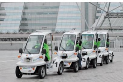
車体前部に取り付けたセンサーによってお互いの車両位置の情報を把握することで、前車に追従するシステムを可能としている。一糸乱れぬ縦列走行によって後車の空気抵抗を減らして燃料消費の削減を図るのが研究の狙い。デモ走行時には、どんな走りをしているのかを丁寧に説明してくれる
