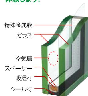
「サンバランス®」は、ガラスの内側の特殊金属膜の働きで、照りつく夏の太陽熱（赤外線）をはね返す。また2枚のガラスの間の空気層で結露を防ぎ、冬は暖房効率を高めてくれる。AGC旭硝子のブースでは、「快適」を体験する装置があるので、住宅用ガラス「サンバランス®」から実現する「スマートな社会」をこの機会にぜひ体験しよう。
