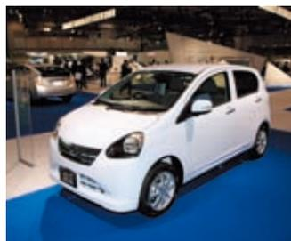
ダイハツが展示するのは市販車である「ミライース」。10・15モード燃費32km/ℓ、JC08モード燃費30.0km/ℓと低燃費を謳う。ボディやパーツの軽量化、アイドリングストップ装置、オルタネーター回生制御などが環境性能を高めた。車名の[e:S]はenergy(エネルギー) saving(省く)のイニシャルから。
