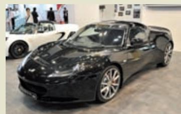
高性能モデルSに追加された、6ATを搭載したエヴォーラS IPS。パドルシフトも備わり、0-100km/h加速5秒、最高速は269km/hとなる。国内には来年春に導入される予定だ
