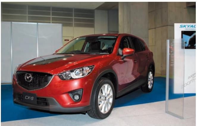
デミオに搭載された新世代技術のSKYACTIVによってもたらされた先進の環境性能を大迫力の3Dシアターを使って公開。また、マツダのデザインテーマである“魂動(こどう)-Soul of Motion”と市販車として初めてSKYACTIV技術を全面採用したCX-5を初披露。世界一の低圧縮比14.0を実現したディーゼルエンジンのSKYACTIV-Dを搭載している。
