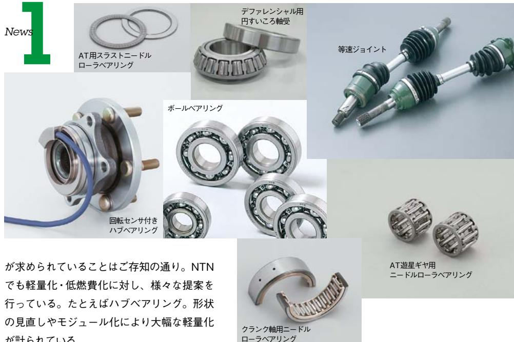
が求められていることはご存知の通り。NTNでも軽量化・低燃費化に対し、様々な提案を行っている。たとえばハブベアリング。形状の見直しやモジュール化により大幅な軽量化が計られている。
